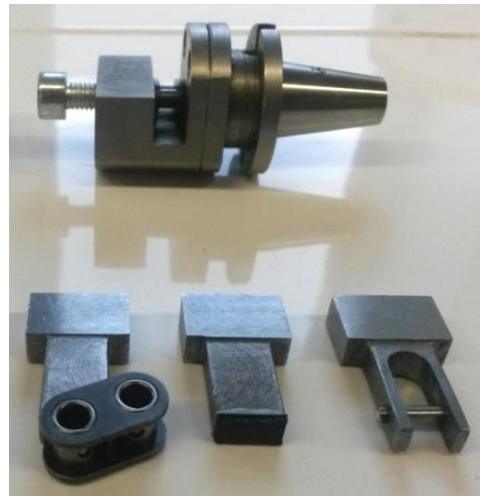
Măsurarea coeficientului de frecare bolt-bucsă pe modulul de mișcarea oscilatorie de rotație (block on ring)
