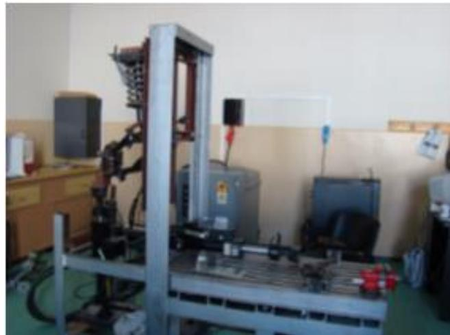
Instalatie experimentală pentru testarea de componente și sisteme mecanice, pe baza de actuatori liniari hidraulici
